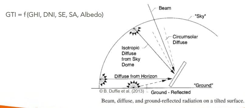
Calculations for Global <u>Horiontal</u> Irradiance GHI = 1000 W/m<sup>2</sup> & Diffuse <u>Horizontal</u> DHI= 200 W/m<sup>2</sup>, solar zenith angle  $\theta_z = 25^{\circ}$
